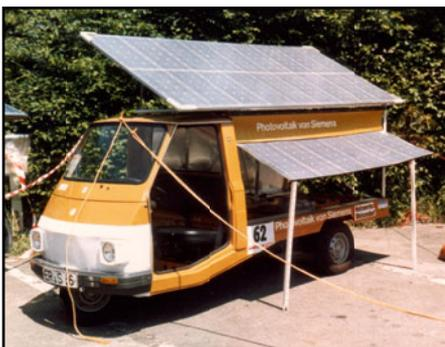
Solare Ladepause mit ausgeklappten Modulen. Wegen der Gewichtersparnis fahren wir ohne Türen, angenehm bei der Hitze.
