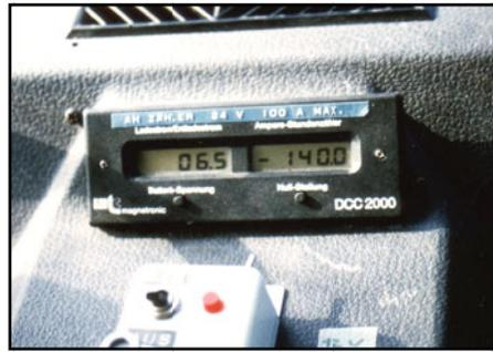
Bewährt hatte sich bei der Nebenherlauf-Aktion auch das auf die Schnelle eingebaute Handgas mit Poti unter dem Ah-Zähler. So konnte mit einer Art Tempomat Funktion das Fahrzeug ohne Fussgas den Berg hoch fahren und musste nur noch gelenkt werden.
