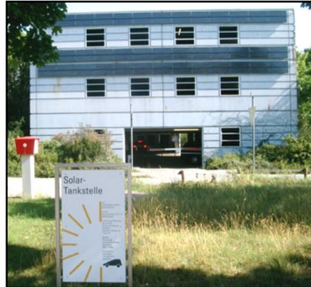
Im **März 1993** wurde am Siemens Parkhaus in der Innenstadt von Erlangen eine 3,3 kW Solaranlage installiert, die dem Solarmobil Verein Erlangen gehört. Dazu kamen 6 Parkplätze und 6 Stromzapfstellen in 3 Biesinger Säulen. Der ursprüngliche Siemens Wechselrichter wurde mittlerweile durch zwei neue und moderne Wechselrichter, ebenfalls von Siemens, ersetzt. Die Anlage ist noch immer im Betrieb.
