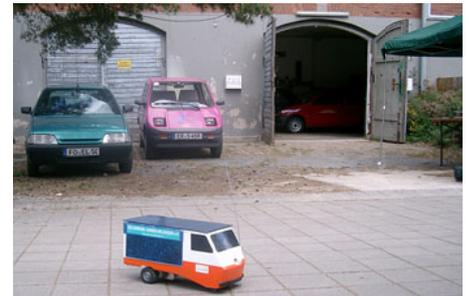
Rechts und links neben dem Tor zur Werkstatt des Vereins erkennt man nach genauem Hinschauen die kleinen weißen Kästen. Dies sind die Stromtankstellen des Vereins. In jedem Kasten sind 3 Schuko und parallel dazu 3 CEE-blau Steckdosen, jeweils mit 16 A abgesichert. Somit können an den zwei Kästen bis zu 6 Fahrzeuge mit je 3,6 kW geladen werden. Vorne fährt das kleine ferngesteuerte Modell des „Erlanger Solarmobils“.
