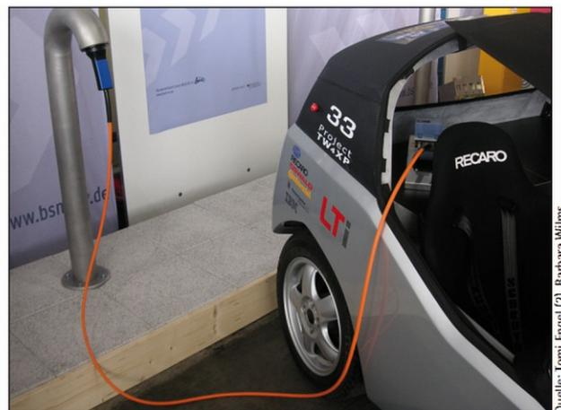
Bild 5: Die unaufdringliche und extrem kostengünstige Stromstelle wird erst durch den neuartigen Ladestecker möglich. Im Fahrzeug kann man das blaue BabelBee-Modul erkennen, welches den dynamischen Ladevorgang regelt.
