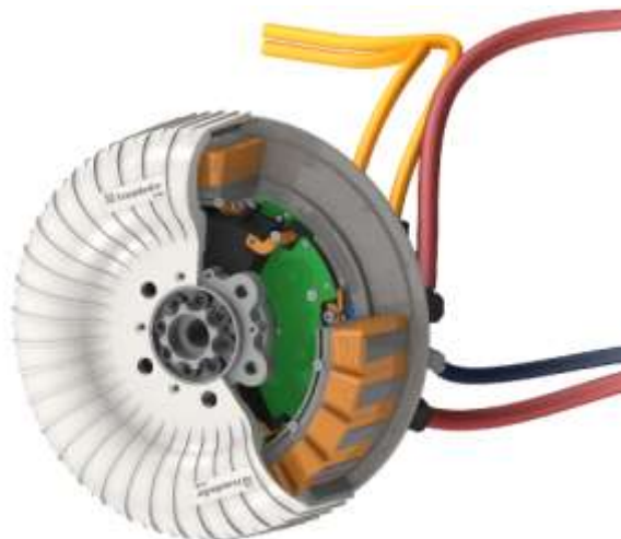
Schnittmodell des Radnabenmotors in der Konstruktion. Ausstellung: Antrieb Zukunft; Foto: Fraunhofer Institut IFAM
